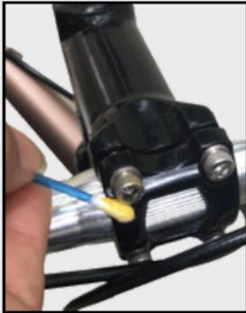
1. Com a ajuda de uma haste flexível, passe uma fina camada de graxa em torno dos parafusos e na sua parte superior. Evite passar no interior do local de encaixe da ferramenta.
