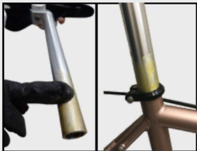
1. Passe uma camada de graxa na extremidade exterior do canote.
